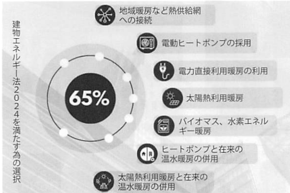
図2 建築エネルギー法(GEG)71条、新築建物の暖房エネルギーの65%は再生可能エネルギーを使用すべし
